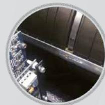
Автоматическое крепление «хвоста» пластины
